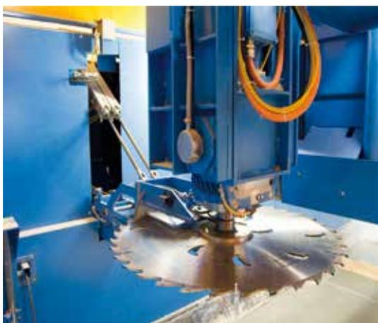
Das 5-Achs-Fräsaggregat mit 38 kW wird vom Werkzeugwechsler mit bis zu 16 Werkzeugen bedient. Je nach Anforderung an das zu bearbeitende Bauteil wird das entsprechende Werkzeug aus dem Magazin automatisch eingewechselt.
