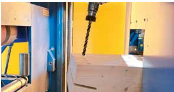
Eine in Längsrichtung verfahrbare Mess- und Vorschubeinheit auf der Auslaufseite sorgt dafür, dass das Bauteil immer möglichst eng eingespannt ist. So werden unnötige Vibrationen beim Bearbeiten vermieden. In Verbindung mit dem hohen Drehzahlbereich des Robot-Aggregats entstehen Oberflächen in Sichtqualität.
