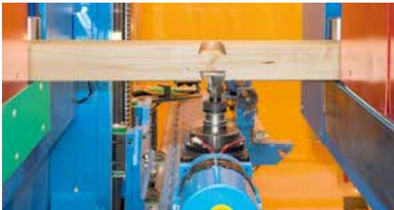
Die Maschine ist so konstruiert, dass das äußerst stabile Robot-Aggregat die Bauteile uneingeschränkt von allen sechs Bauteilseiten anfahren und in allen möglichen Winkeln und Neigungen bearbeiten kann. Das Wenden der Bauteile oder gar ein zweiter Durchlauf entfallen selbst bei den größten Holzquerschnitten. Das Ergebnis sind absolute Genauigkeit und Präzision.
