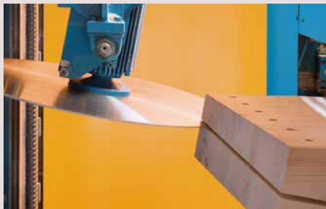
Im Gegensatz zu einer Lösung mit Untertischkappsäge kann das Sägeblatt unter die Nullposition schneiden und Schlitz in beliebigen Winkeln und in allen benötigten Stärken fertigen.
