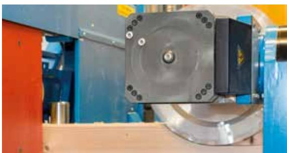
Falls noch mehr Leistung gefordert wird, kann das Robot-Aggregat alternativ auch mit einer wassergekühlten 29 kW Hochleistungsspindel mit bis zu 15 000 U/min ausgerüstet werden.
