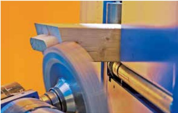
Abgraten, kehlen, bohren, fräsen, schlitzen und markieren oder beschriften - mit dem jeweils benötigten Werkzeug im Magazin sind den Bearbeitungsmöglichkeiten nahezu keine Grenzen gesetzt.
