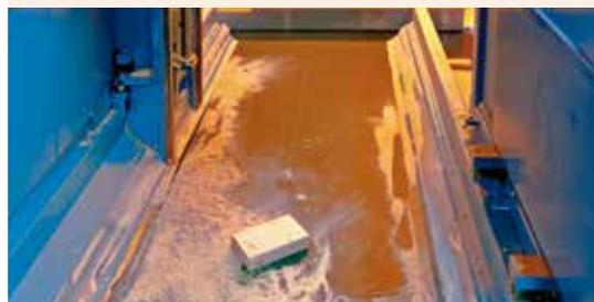
Zusätzlich gibt es für eine sichere Trennung von Spänen und Reststücken auch einen Steigförderer mit Abfalltrennung.
