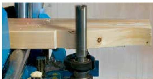
Zur Auswahl stehen dabei ein 7,5 kW-Fräs- und Bohraggregate für das Fräsen von Falzen, Aussparungen oder frei programmierbaren Profilen sowie ein 2,2 kW-Bohraggregate für die Herstellung von Durchgangs- oder Sacklochbohrungen.
