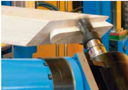
Schwalbenschwanz- verbindungen am Schifter
