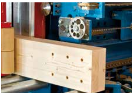
Beliebige Bohrbilder, horizontal und vertikal
