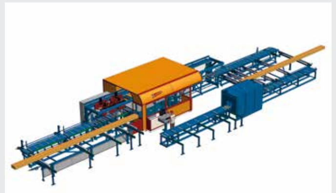
Abbundmaschine mit Hobeln nach dem Abbund
