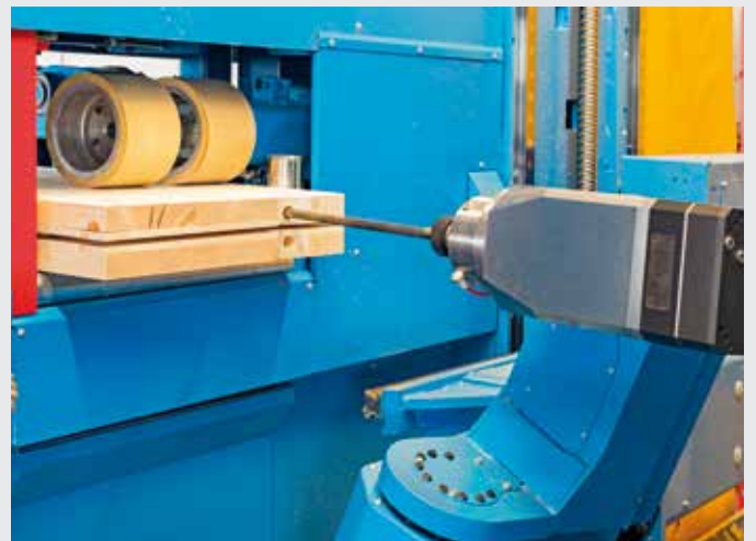
Für spezielle Anwendungen können Bohrer bis d=50 mm und einer Nutzlänge von 420 mm gefahren werden
