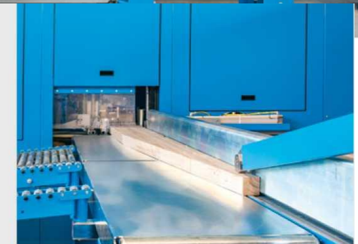
Töödeldava detaili kontrollitud transport stabiilse haaratsvankri abil.
