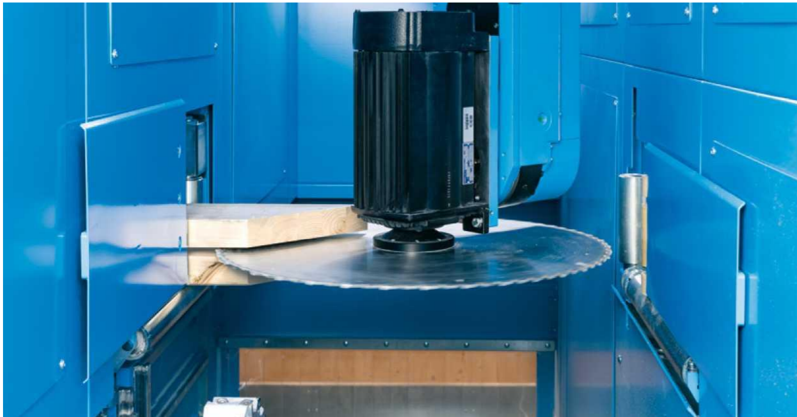
Pikisuunalised lõiked, otste mahalõikamine ja soonte lõikamine tehakse Ø720 mm saekettaga.
