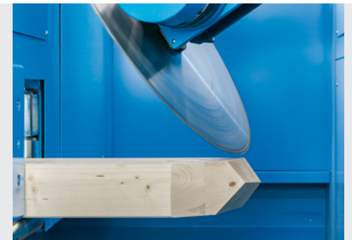
Neigungs- oder Schifterschnitte in allen möglichen Winkeln und Neigungen.
