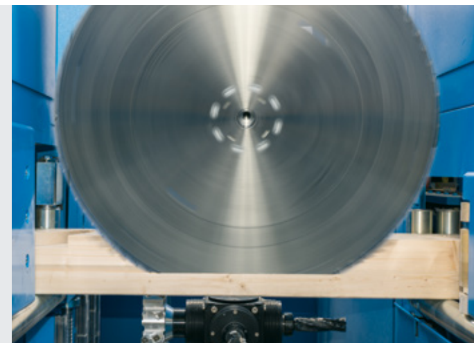
Längsschnitte, Abgratungen oder Auskehlungen werden mit dem Ø 720 mm Sägeblatt gefertigt.
