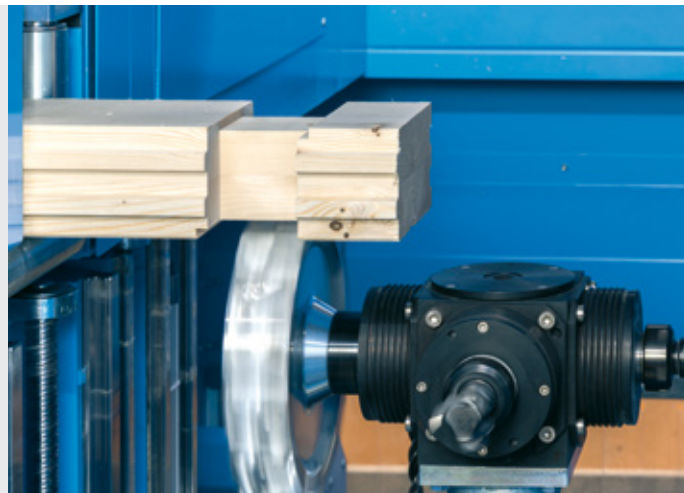
Ausblattungen sind an allen 6 Bauteilseiten möglich.
