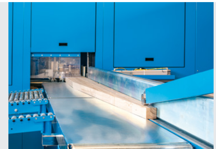
Kontrollierter Werkstücktransport mit dem stabilen Greiferwagen.
