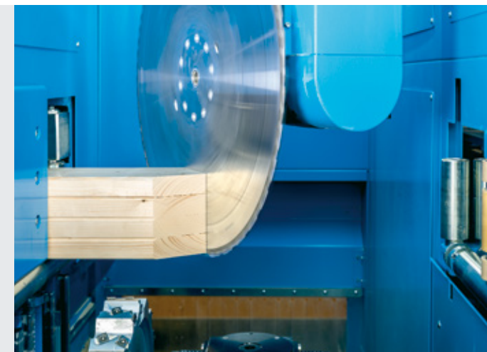
Gleichzeitige präzise Bearbeitung von mehreren aufeinandergestapelten Bauteilen.
